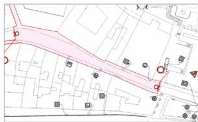
A II. ütem átépítési munkái alatt a forgalmi rend a fenti ábra szerint módosul, a gyalogosforgalom folyamatos biztosítása mellett.
